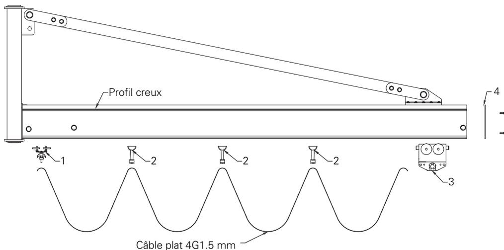
1. Introduire le chariot fixe **1** dans le bras de la flèche jusqu'en butée contre le pivot. Visser les deux boulons de manière à immobiliser celui-ci.
