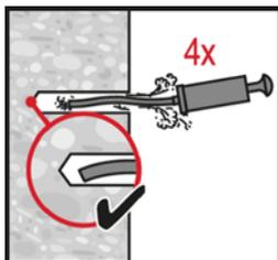
Nettoyage manuel pour les trous forés  $d_0 \leq 18$  mm et trous de profondeurs  $h_0 \leq 10 d_0$ .
