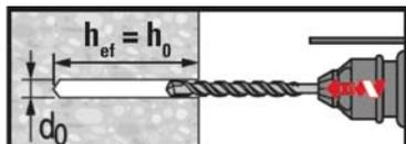
Perçage par rotation percussion (béton sec et humide, pas d'eau de mer).
