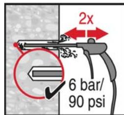
Nettoyage par air comprimé pour les trous perforés  $d_0$  et trous forés de profondeurs  $h_0$ .
