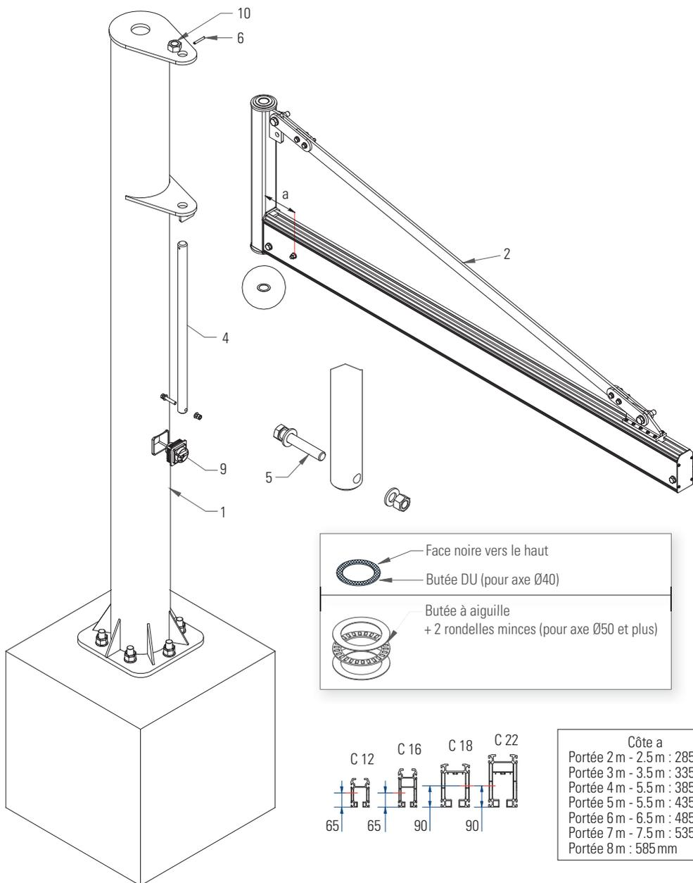
1. Monter le fût **1** de la potence sur ses tiges d'ancrage en faisant reposer le dessous de la semelle sur une rangée d'écrous M27 **7** (fournis avec les tiges).
