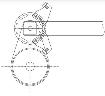
4. Assembler la deuxième butée sur la coquille de la même façon qu'en phase 2.
